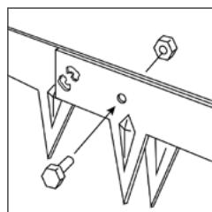
Vous pouvez si vous le souhaitez fixer les parties qui dépassent en y perçant un trou et en fixant les parties les unes aux autres à l'aide d'un boulon et d'un écrou. Utilisez pour la version noire une couche primaire afin de protéger les matériaux contre la corrosion.
